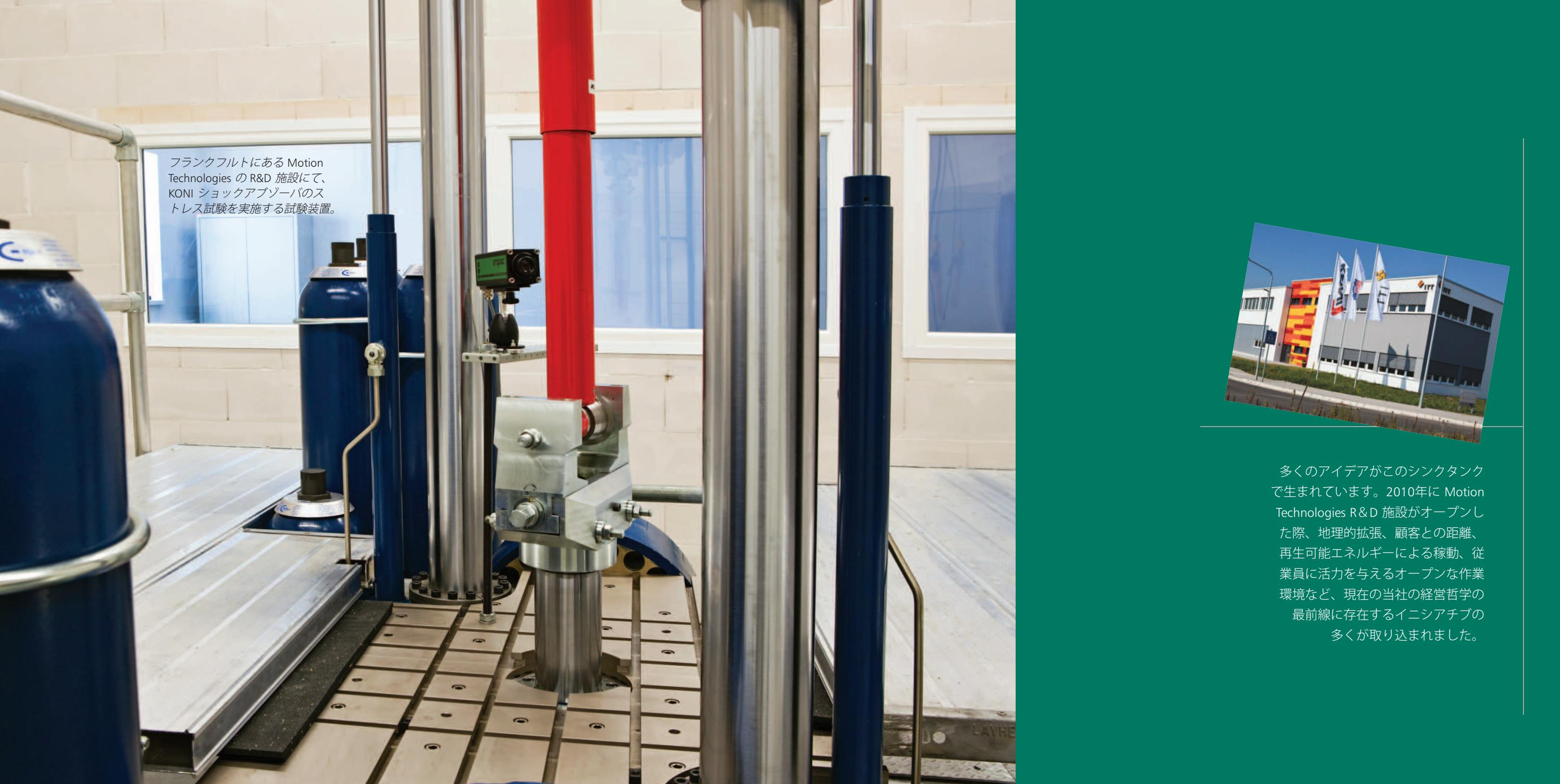
フランクフルトにある Motion Technologies の R&D 施設にて、KONI ショックアブソーバのストレス試験を実施する試験装置。
